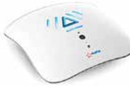
Detta **Hub**, è il cuore del sistema, la **base che gestisce l'intero sistema Edison Smart Living** e a cui colleghi tutti gli smart device. Integra una **videocamera** con scheda SD, una **sirena d'allarme**, una batteria per supplire ai cali di tensione e una scheda 3G che agisce da **Hotspot Wi-Fi**.
